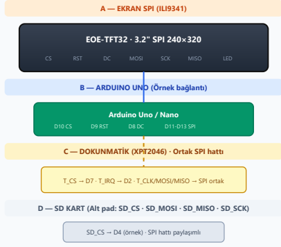
Şekil 2 — Arduino Uno örnek pin bağlantısı (pinler projeye göre değiştirilebilir)
